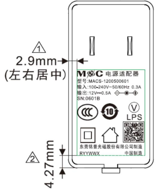
10、 STRUCTURE AND DIMENSION 结构尺寸规格
